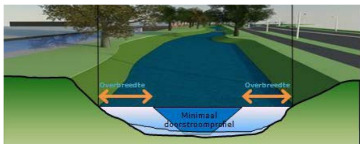
Schematische weergave van een slootprofiel (bron: HHNK)
