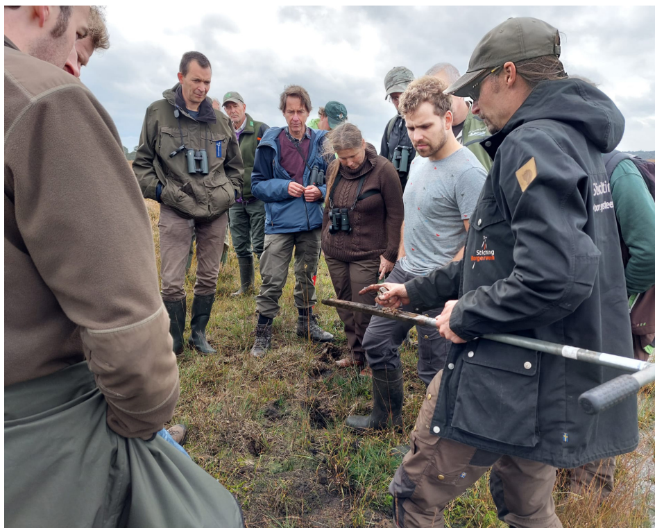
Versluijs toont de slecht doorlatende laag in de moerige grond van het voormalige hoogveen.
